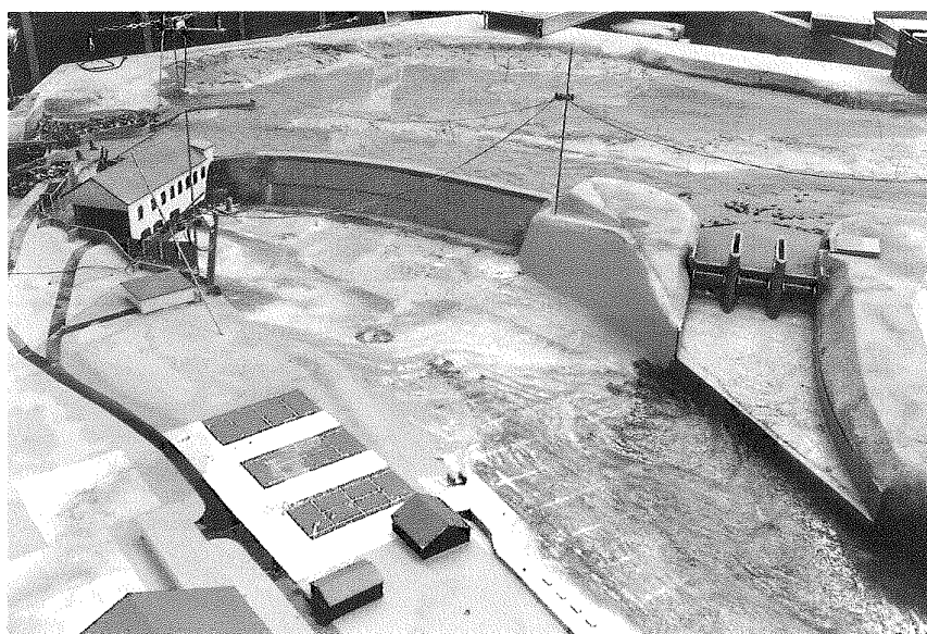
Fig. 6. Modèle hydraulique de l'aménagement de l'Oelberg-Maigrage réalisé au Laboratoire de Constructions Hydrauliques de l'EPFL (échelle géométrique 1:50).
